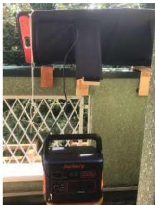
写真は、出力 100W のポータブルパネルと容量 1kWh の蓄電池です。晴れた日は 0.5~0.7kWh 程度、発電することができます。
